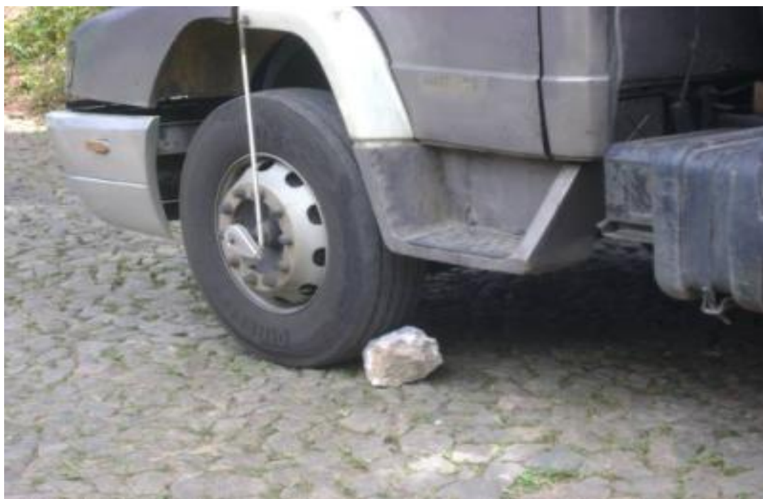
Foto 03: Calçamento da roda do veículo irregular.
