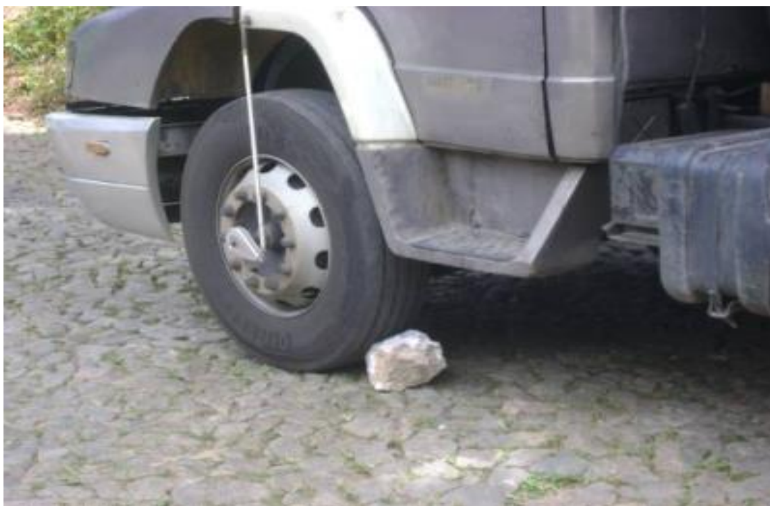
Foto 03: Calçamento da roda do veículo irregular.
