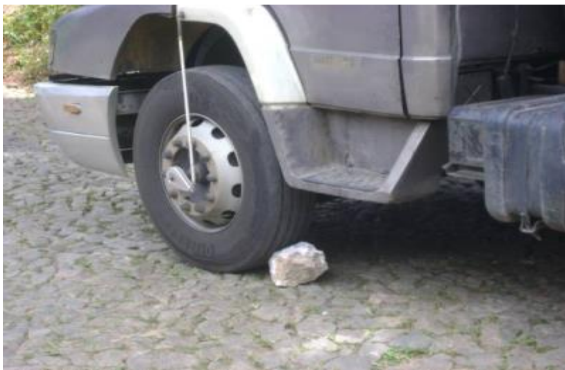
Foto 03: Calçamento da roda do veículo irregular.
