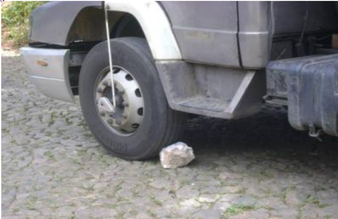
Foto 03: Calçamento da roda do veículo irregular.
